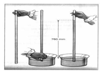
Abriu, em seguida, a extremidade que havia tampado, para que o mercúrio escoasse para o vaso. Verificou, então, que o mercúrio desceu no tubo e se estabilizou a uma altura da ordem de 760 mm em relação à superfície do mercúrio no vaso.
